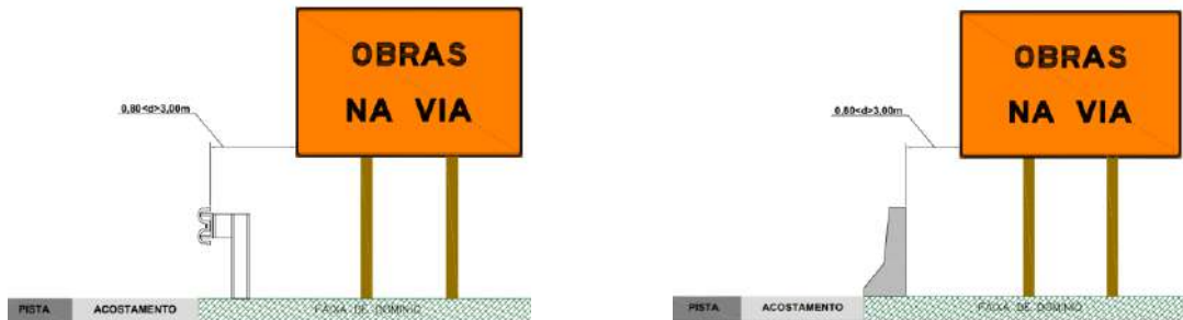
Figura 12– Placas de Solo - Afastamento Lateral - Dispositivos de Proteção Contínua
