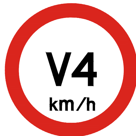
Placa: V4 Dimensões: \phi = 1,20 m Chapa: Aço 18 Película fundo: III (Edital Br Legal) Película elementos: III (Edital Br Legal)
