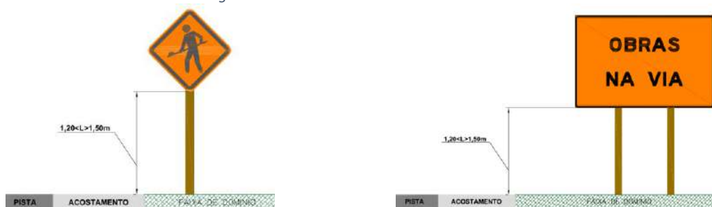
Figura 10– Placas de Solo – Altura
