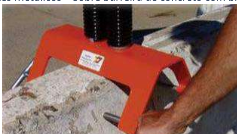
Figura 19– Suportes Metálicos – Sobre barreira de concreto com braçadeiras
