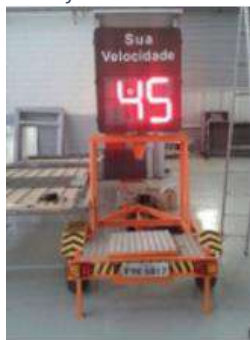
Figura 60– Painel Informador de Velocidade
