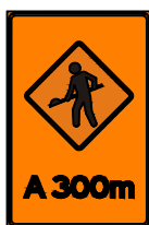
Placa: AC24-300 Dimensões: 1,0 x 1,5 m Chapa: Aço 18 Película fundo: III (Edital Br Legal) Película elementos: X (Edital Br Legal)
