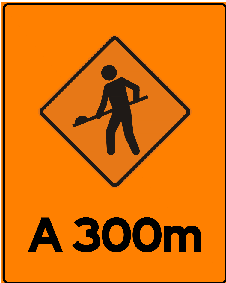
Placa: AC24-300 Dimensões: 2,0 x 2,5 m Chapa: Aço 18 Película fundo: III (Edital Br Legal) Película elementos: X (Edital Br Legal)
