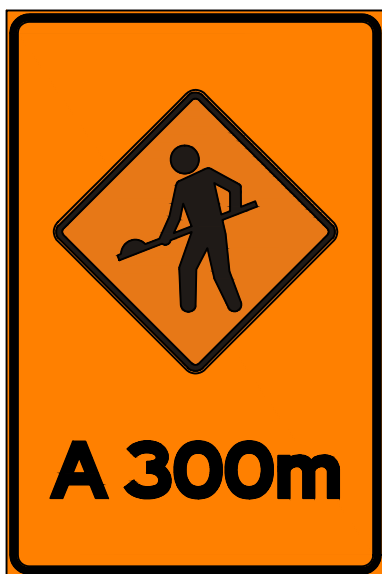
Placa: AC24-300 Dimensões: 1,0 x 1,5 m Chapa: Aço 18 Película fundo: III (Edital Br Legal) Película elementos: X (Edital Br Legal)
