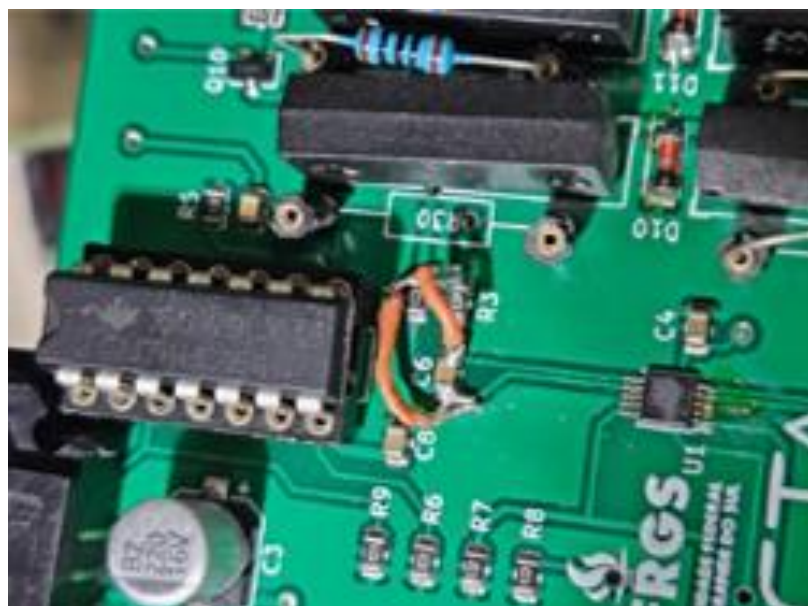
Figura 36. Jumpers evitando o filtro no Módulo de Entrada.
